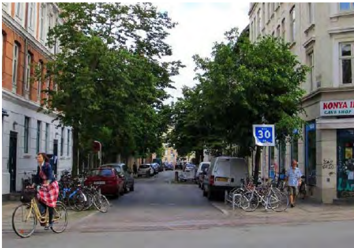
Illustration 31 : À Copenhague, la signalisation, les plantations et les supports à vélo constituent un très bon effet de porte et les traverses texturées rétablissent une continuité pour les piétons. Photo : La Citta Vita CC
