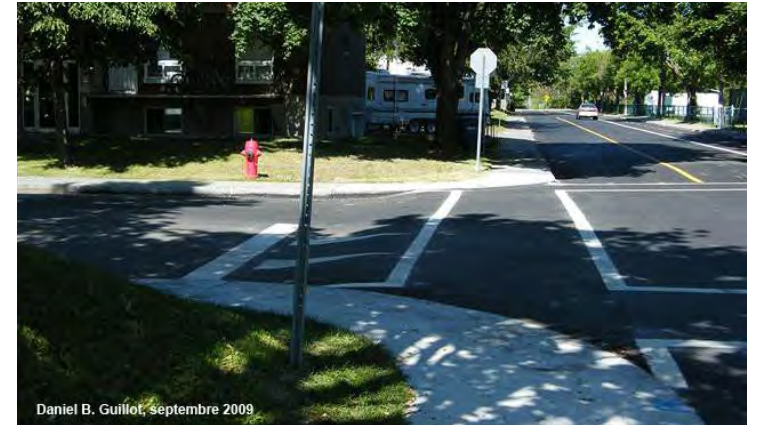
Illustration 33 : Cette intersection surélevée située au coin de la 8 e avenue et de la 23 e rue crée un obstacle physique qui force l'automobiliste à ralentir à l'approche de l'intersection. Photo : Daniel B. Guillot, 2009
